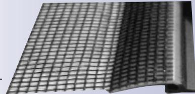
Für Gewebearbindungen bei Klebewellen verwenden wir als Verbindungssystem effizientes **doppelseitiges Klebeband**. Die Anbindung des Gewebes an die Welle erfolgt teilautomatisiert.
